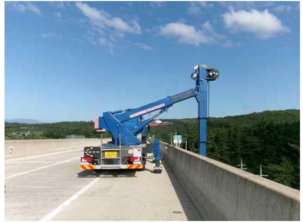
굴절점검차를 이용한 근접조사
